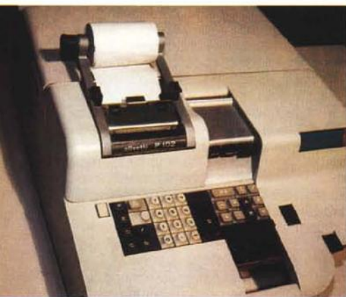
La Olivetti Programma 101 (in foto il modello 102) uscì nel 1965; un elaboratore elettronico personale programmabile completamente transistorizzato che rimase ineguagliato fino a tutto il 1969. Ne furono venduti in tutto il mondo oltre 40 mila esemplari. Fu il primo vero Personal Computer della storia dell'informatica.
